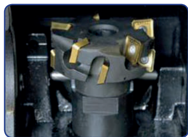
Моноблочная фрезерная головка с 10 многогранными режущими пластинами, закрепленными при помощи болтов
