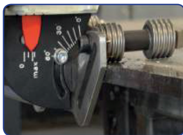
Постоянная регулировка угла от 0 до 60 градусов
